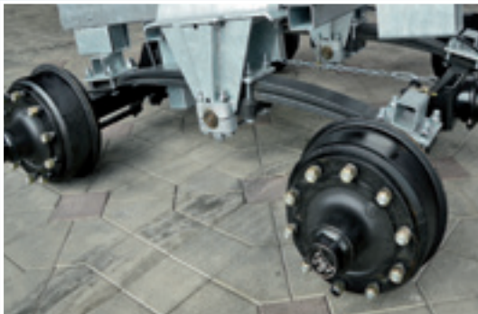
Suspensie Titan Tandem cu 2 seturi de arcuri parabolice
