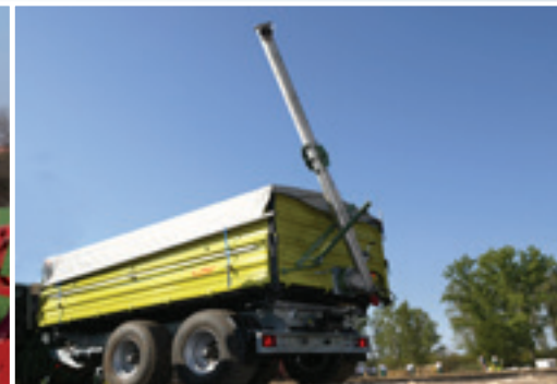
Șnec de descărcare cu diametrul de 168 mm, lungimea de 3000 mm și 4000 mm, din oțel de calitate, galvanizat, ușor de asamblat, cu trolu pentru cablu și reductor pentru acționarea melcului
