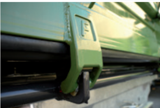
Sistem de închidere obloane lateral - echipare standard disponibilă începând de la modelul EDK 60 , iar pentru modele cu lungimea mai mare de 4500 mm basculanta are 6 sisteme de închidere integrate de profilul platformei
