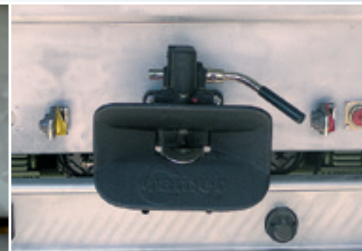
Cuplă automată de remorcaj și cuple frânare (hidraulică /pneumatică) pentru a doua remorcă
