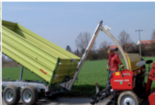
Șnec de descărcare cu diametrul de 168 mm, lungimea de 3000 mm și 4000 mm, din oțel de calitate, galvanizat, ușor de asamblat, cu trolu pentru cablu și reductor pentru acționarea melcului
