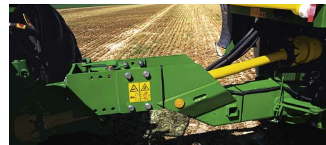
Bara de tracțiune și direcție subțire evită interferențele cu roțile tractorului
