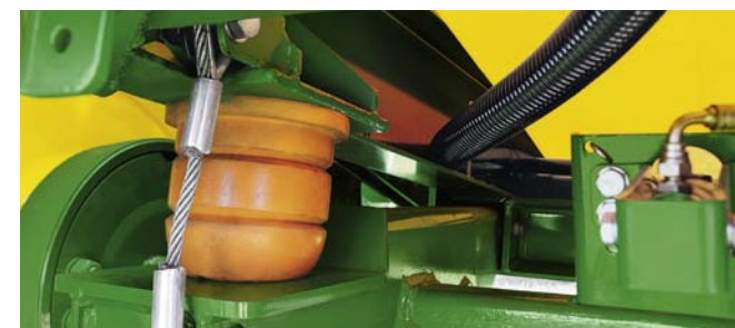
Suspensie axială cu legătură dublă opțională pentru pulverizare precisă și fină, precum și viteze mai mari de transport pe drum
